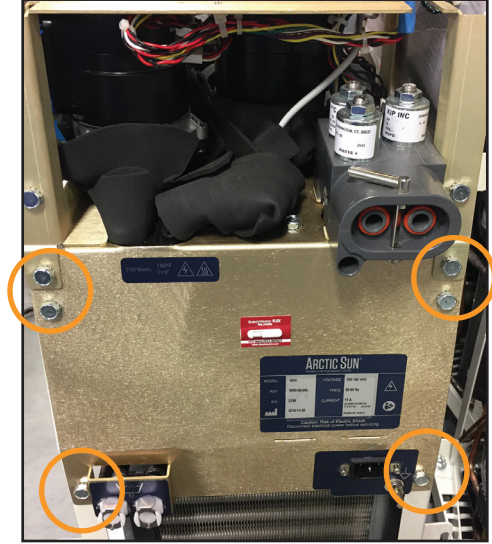
Şek. 8-36 Altı civatayı çıkarın (Adım 3)
