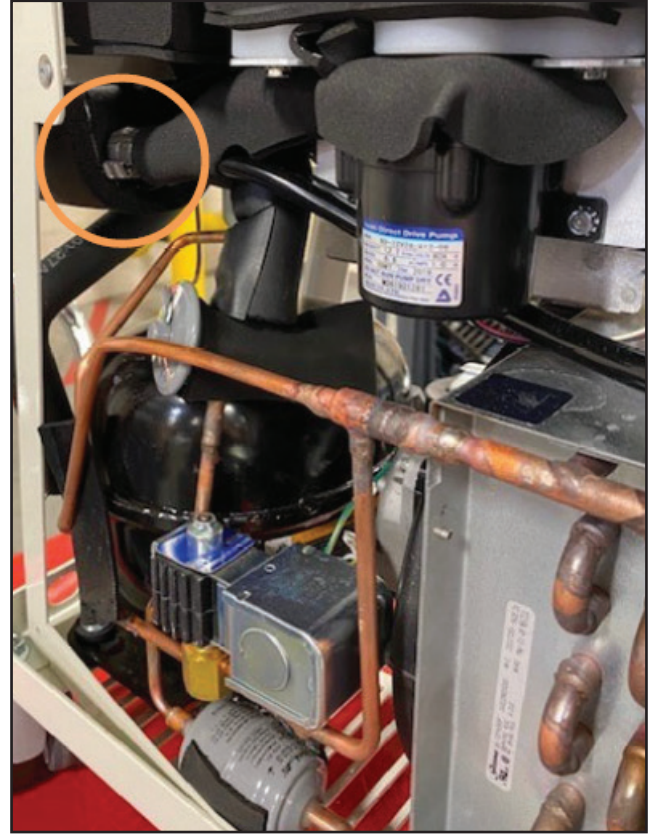
Şek. 8-22 İki kelepçeyi ayırın (Adım 3 – DC pompası)
