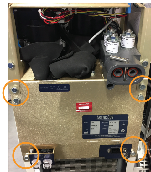
Fig. 8-36 Retrait des six boulons (étape 3)
