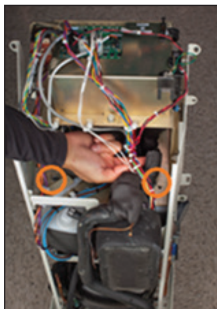
Fig. 8-17 Retrait des deux boulons (étape 2)
