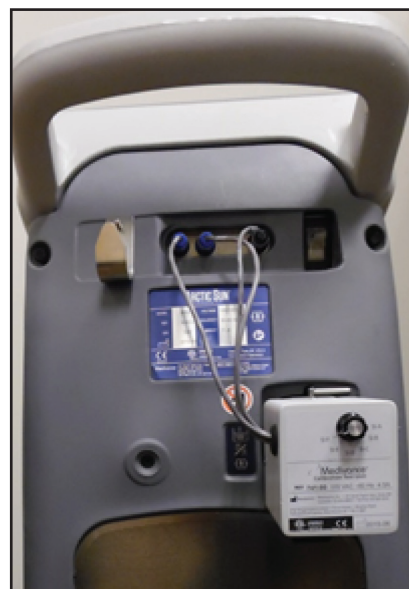
Fig. 9-3 Branchement des câbles (étape 2)
