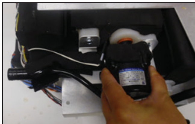
Fig. 8-47 Réinstallation de la pompe (étape 6) (deux vues)
