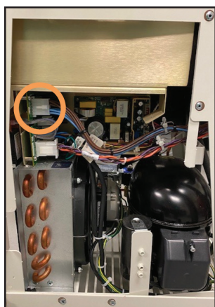
Fig. 7-4 Emplacement du connecteur
