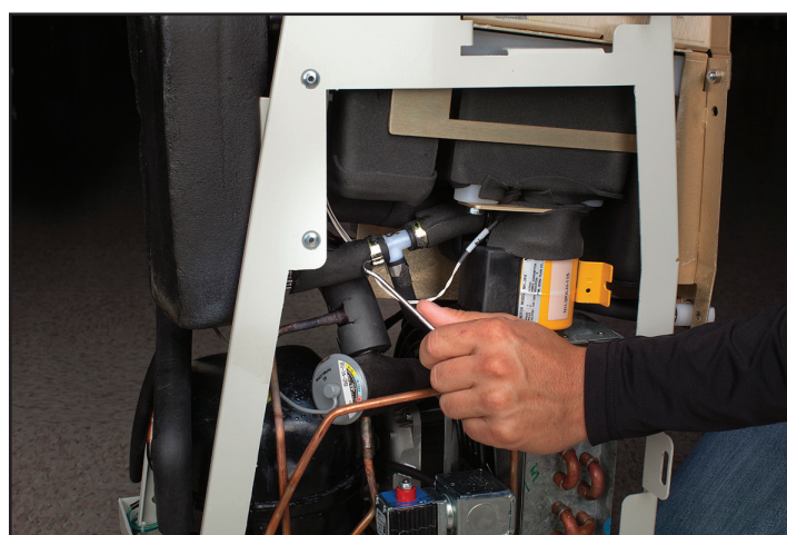
Fig. 8-21 Ouverture du raccord encliquetable (étape 3 - pompe CA)
