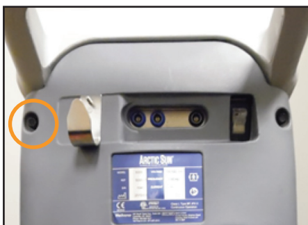
Fig. 8-72 Retrait du boulon (étape 1)
