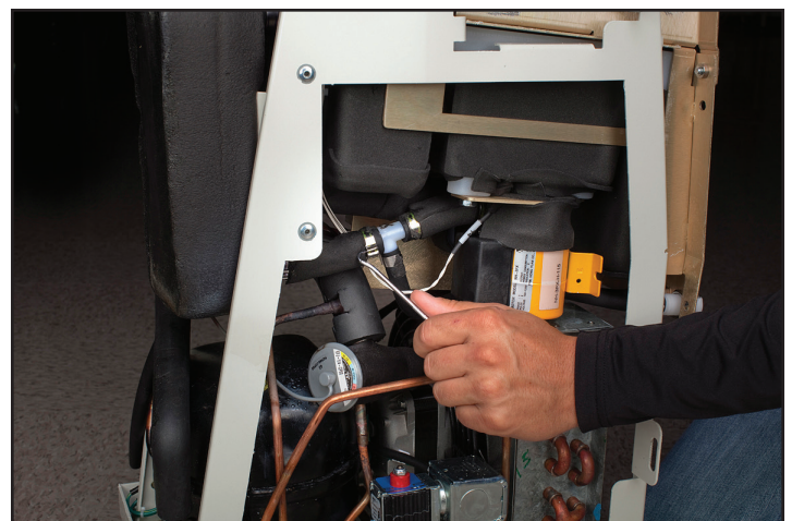
Afb. 8-21 Open de kliksluiting (stap 3 – Wisselstroompomp)
