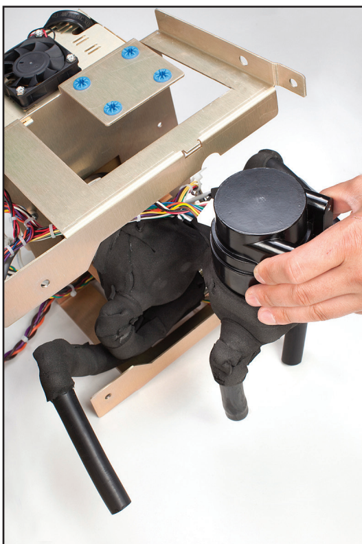
Afb. 8-31 Verwijder de mengpomp voorzichtig (stap 5).
