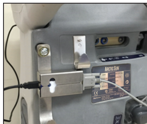
Afb. 8-74 TIM plaatsen en kabels aansluiten (stap 3-5)
