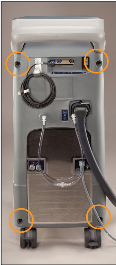
Afb. 8-10 Achterpaneel met aanduiding van de te verwijderen bouten (stap 2, links)
