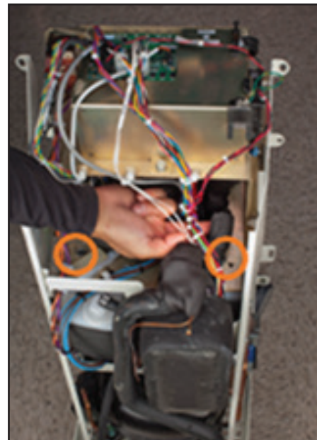
Afb. 8-17 Verwijder twee bouten (stap 2)
