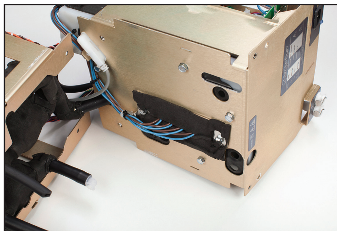
Fig. 8-49 Rezervor și încălzitor cu indicarea legăturilor cablurilor care trebuie scoase (pasul 2)
