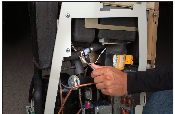
Fig. 8-21 Deschideți racordul cu clichet (pasul 3 – pompă AC)
