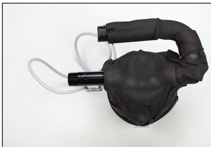
Fig 8-53 Debitmetru cu săgeată care indică direcția de curgere; aceeași direcție ca și ieșirea pompei de circulație
