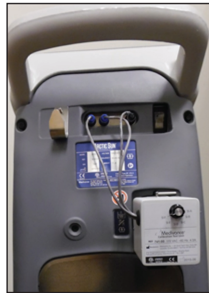
Fig. 9-3 Atașați cablurile (pasul 2)
