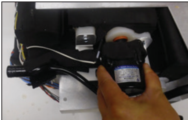
Fig. 8-47 Reinstalați pompa (pasul 6) (două vederi)
