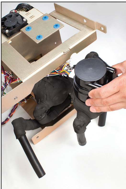
Fig. 8-31 Scoateți cu grijă pompa de amestecare (pasul 5).
