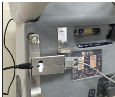
Fig. 8-74 Introduceți TIM și conectați cablurile (pașii 3-5)
