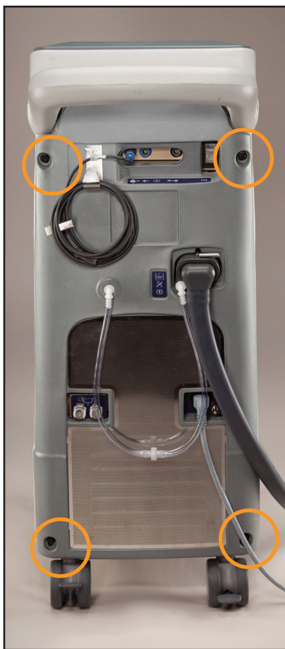
Fig. 8-10 Panoul din spate cu indicarea șuruburilor care trebuie îndepărtate (pasul 2, stânga)
