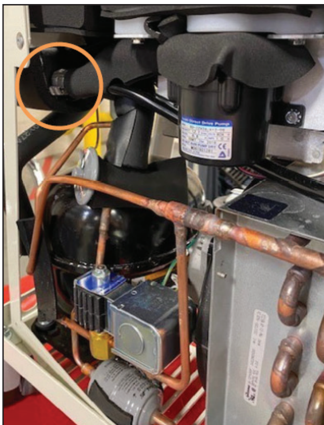
Fig. 8-22 Deconectați două cleme (pasul 3- pompa DC)
