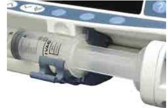
5. Aperte as pegas dos dedos no suporte do êmbolo e deslize o mecanismo para a esquerda até chegar à extremidade do êmbolo.
