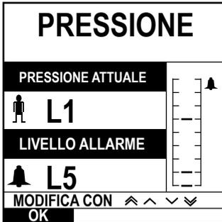
Per controllare e regolare il livello di pressione, premere il pulsante . La visualizzazione cambia, mostrando l'attuale livello della pressione di pompaggio e il limite di allarme della pressione. Il limite di allarme predefinito della pressione può essere impostato per mezzo di Alaris™ Editor.
