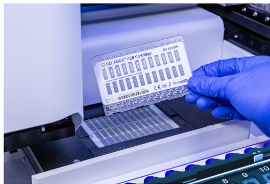
**Figura 2:** Caricamento delle BD MAX PCR Cartridges
