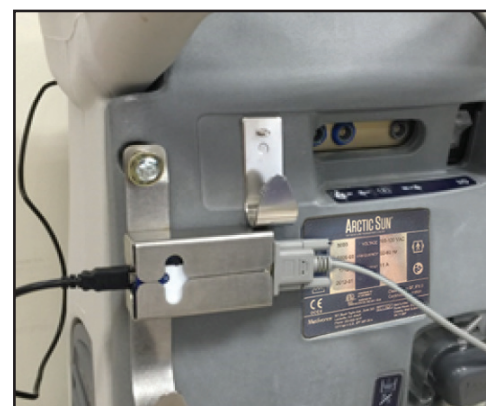
Εικ. 8-74 Εισαγωγή TIM και σύνδεση καλωδίων (Βήματα 3-5)
