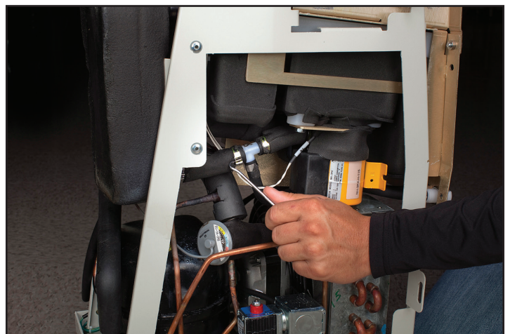
Εικ. 8-21 Ανοιγμα του ελατηριωτού συνδέσμου (Βήμα 3 – αντλία AC)
