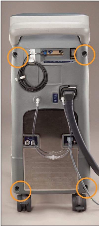
Εικ. 8-10 Το πίσωθιο πάνελ στο οποίο υποδεικνύονται τα μπουλόνια που πρέπει να αφαιρεθούν (Βήμα 2, αριστερά)
