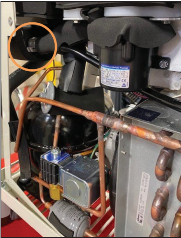
Εικ. 8-22 Αποσύνδεση των δύο σφικτηρών (Βήμα 3 – αντλία DC)
