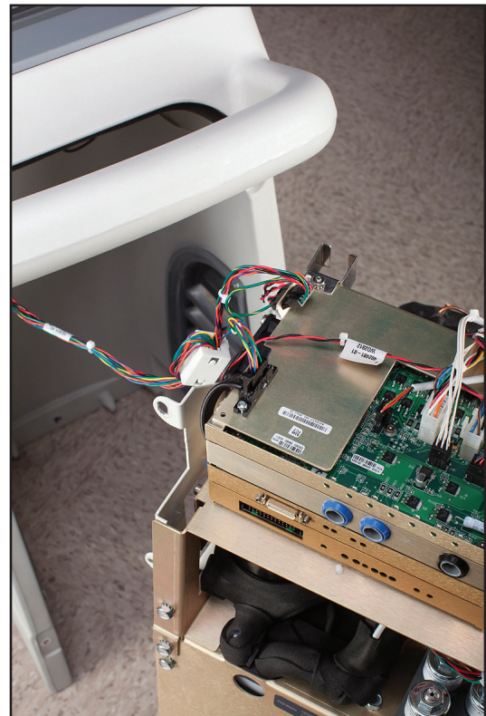
Εικ. 8-12 Πλεξούδες καλωδίων που πρέπει να αφαιρεθούν (Βήμα 3)
