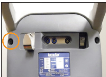
Slika 8-72 Uklanjanje vijaka (1. korak)
