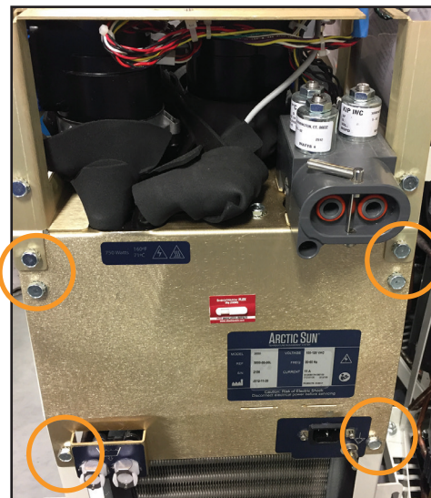
Slika 8-36 Uklanjanje šest vijaka (3. korak)
