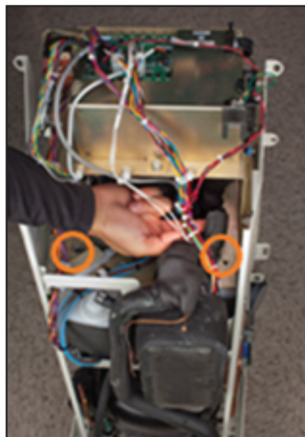
Slika 8-17 Uklanjanje dva vijka (2. korak)
