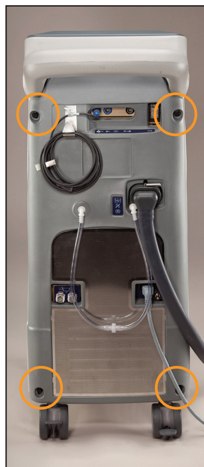
Obr. 8-10 Zadní panel s označením šroubů, které mají být odstraněny (krok 2, vlevo)
