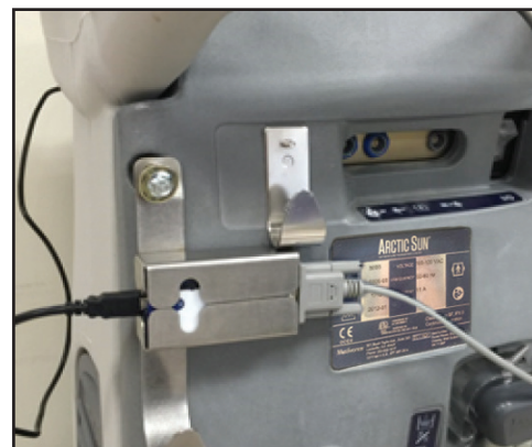
Obr. 8-74 Vložte TIM a připojte kabely (kroky 3-5)
