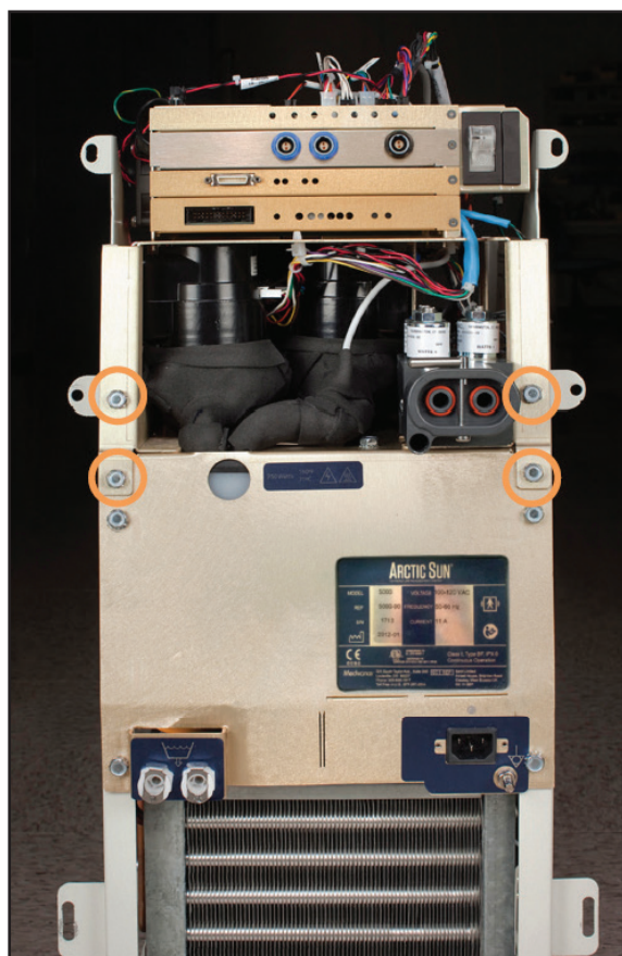
Fig. 8-16 Fjern fire bolte (trin 1)
