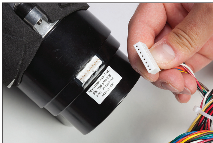
Fig. 8-32 Illustration af pumpestik inden tilslutning (herover), tilsluttet, men sat forkert med et ben, der stikker ud (nedenfor til venstre) og sat rigtigt (nedenfor til højre)
