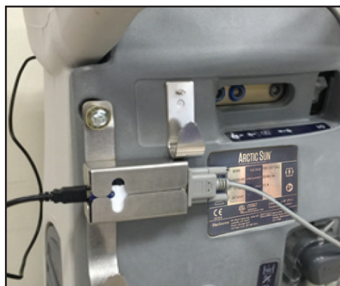
Fig. 8-74 Monter TIM, og forbind kablerne (trin 3-5)
