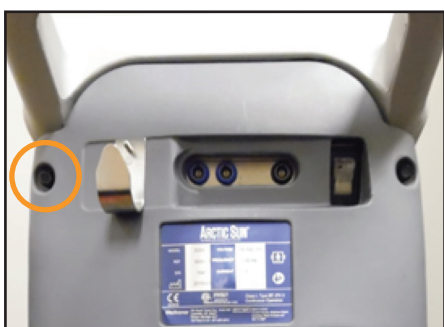
Fig. 8-72 Fjern bolten (trin 1)
