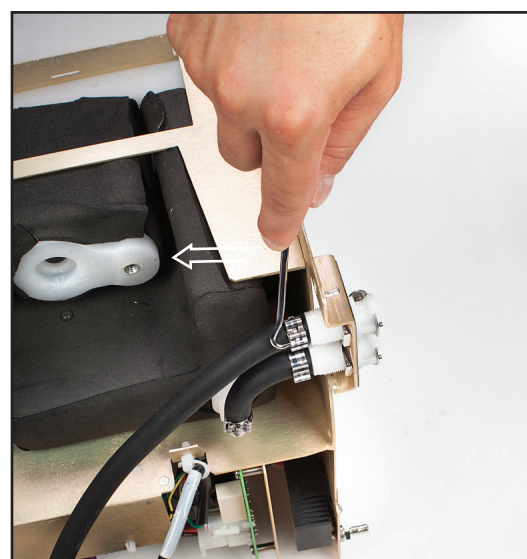
Fig. 8-43 Åbn klemmen, der forbinder kølepumpens slanger med dræventilen
