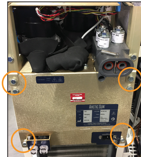
Fig. 8-36 Fjern seks bolte (trin 3)
