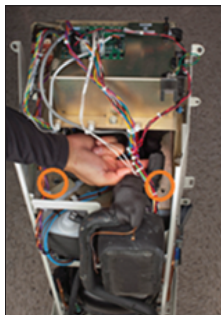
Fig. 8-17 Fjern to bolte (trin 2)
