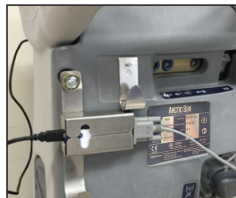
Afb. 8-74 TIM plaatsen en kabels aansluiten (stap 3-5)
