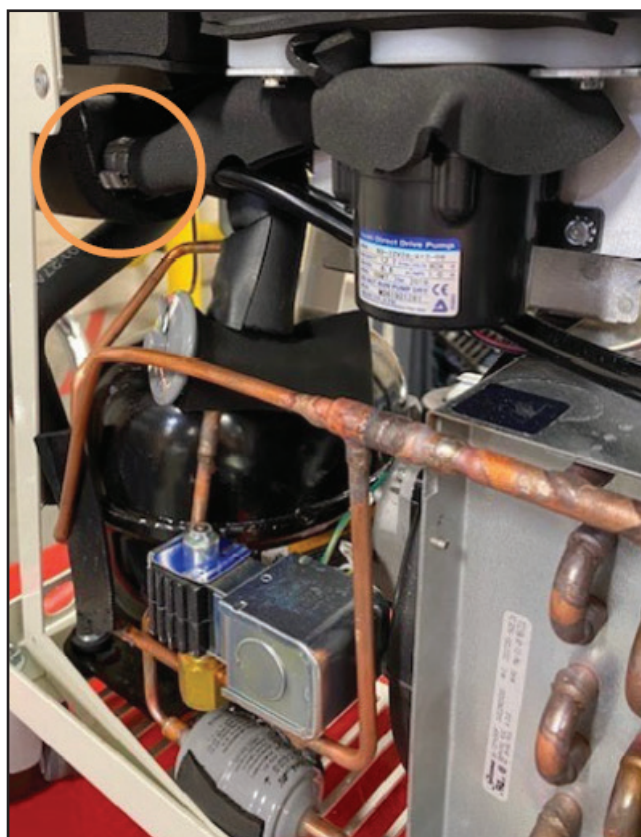
Afb. 8-22 Ontkoppel twee klemmen (stap 3 – Gelijkstroompomp)
