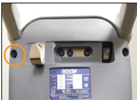
Fig. 8-72 Retrait du boulon (étape 1)
