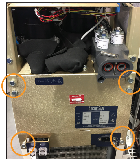
Fig. 8-36 Retrait des six boulons (étape 3)
