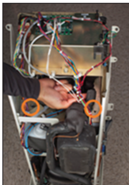
Fig. 8-17 Retrait des deux boulons (étape 2)
