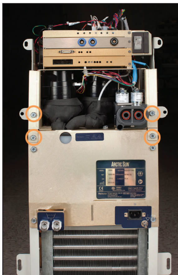
Fig. 8-16 Retrait des quatre boulons (étape 1)
