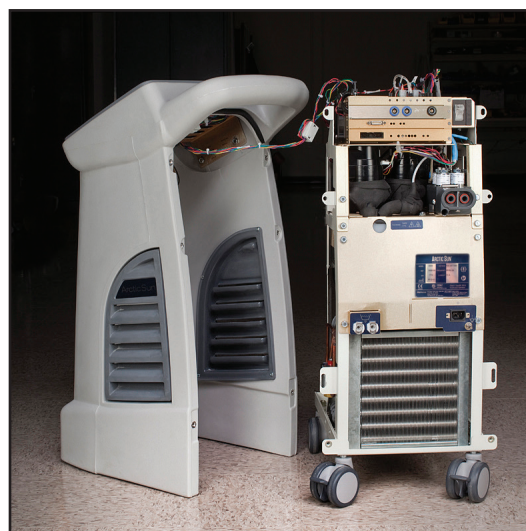
Fig. 8-13 Coque séparée des composants internes
