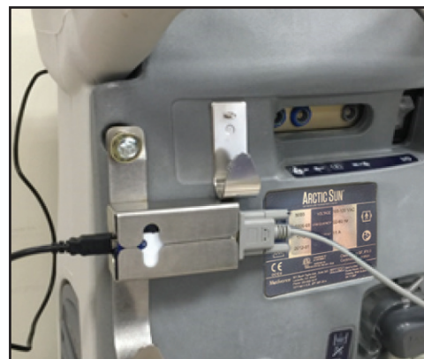
Fig. 8-74 Insertion du module de l'interface de transmission et raccordement des câbles (étapes 3 à 5)
