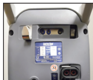
Fig. 9-2 Branchement de la CTU (étape 1)
