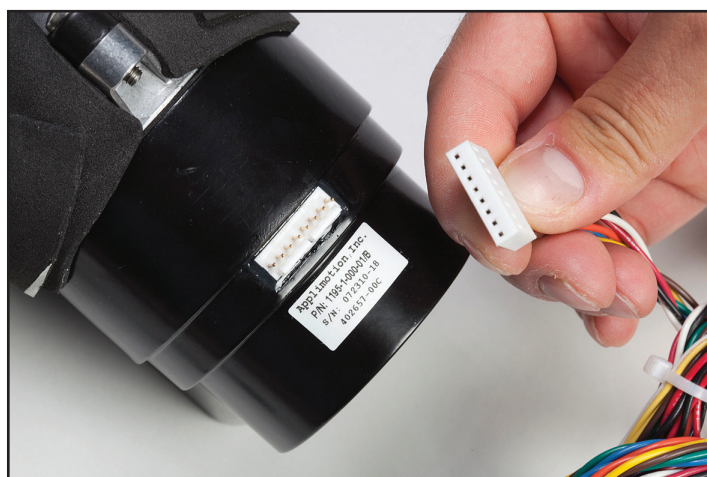
Fig. 8-32 Illustrazione del connettore della pompa prima di essere collegato (sopra), collegato ma posizionato in modo errato con un pin esposto (in basso a sinistra) e posizionato correttamente (in basso a destra)
