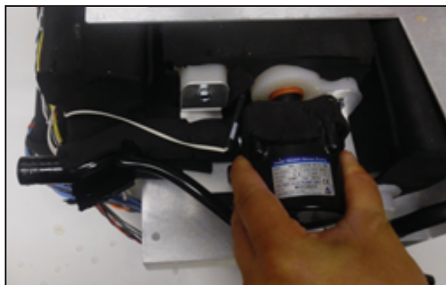
Fig. 8-47 Reinstallare la pompa (Passaggio 6) (due viste)
