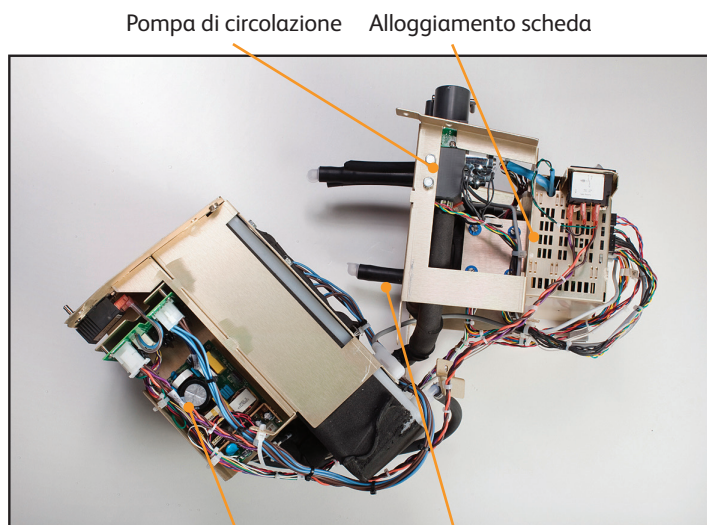
Fig. 8-26 Componenti interni prima di essere separati in due sezioni (2 viste)
