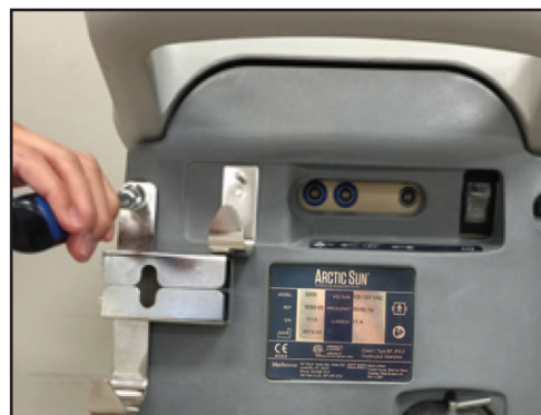
Fig. 8-73 Fissare la staffa (Passaggio 2)
