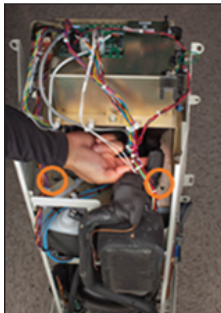
Obr. 8-17 Vyberte dve skrutky (krok 2).
