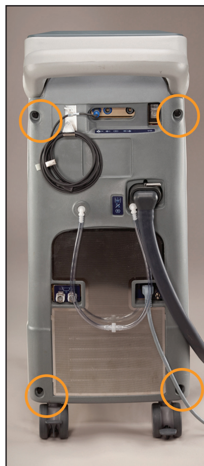
Obr. 8-10 Zadný panel s indikáciou skrutiek, ktoré sa majú odstrániť (krok 2, vľavo).
