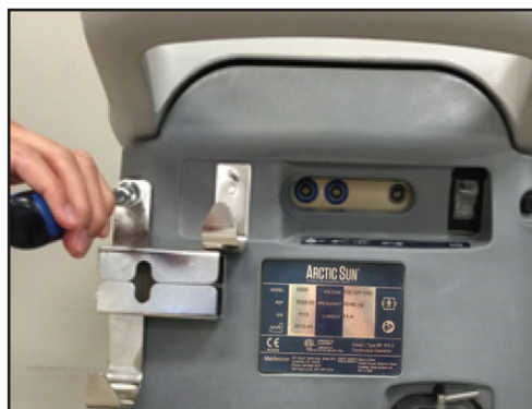
Obr. 8-73 Zaistite konzolu (krok 2).
