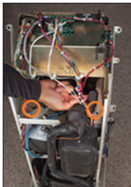
Fig. 8-17 Retire los dos pernos (paso 2)
