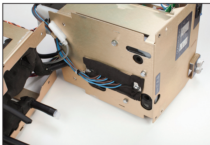
Fig. 8-49 Depósito y calentador con indicación de las bridas de los cables que se deben retirar (paso 2)
