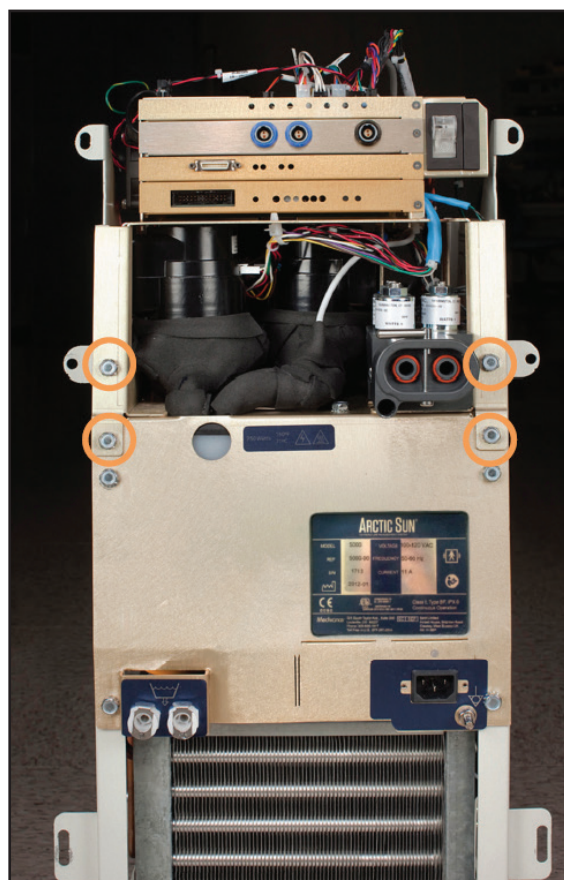
Fig. 8-16 Retire los cuatro pernos (paso 1)
