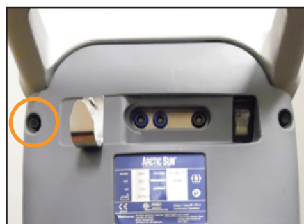
Fig. 8-72 Retire el perno (paso 1)
