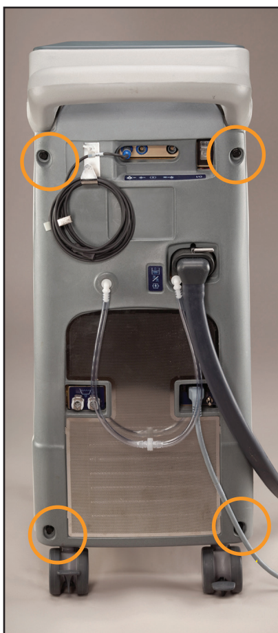
Fig. 8-10 Panel trasero con indicación de los pernos que se deben retirar (paso 2, izquierda)
