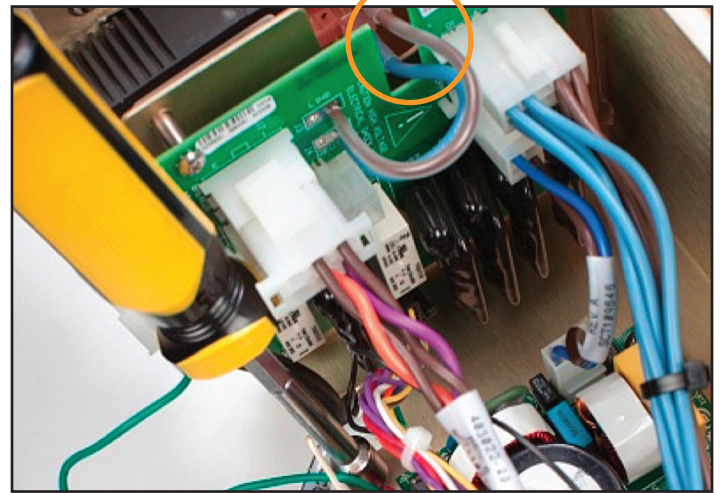
Fig. 8-69 Tarjeta del circuito de tensión principal en su posición, con las conexiones en su lugar
