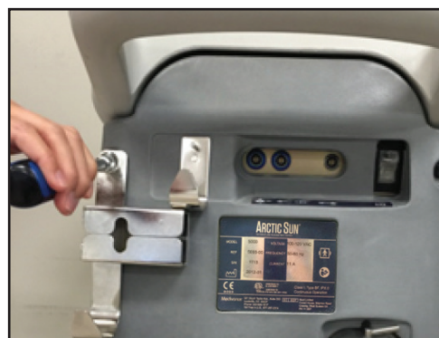
Fig. 8-73 Asegure el soporte (paso 2)
