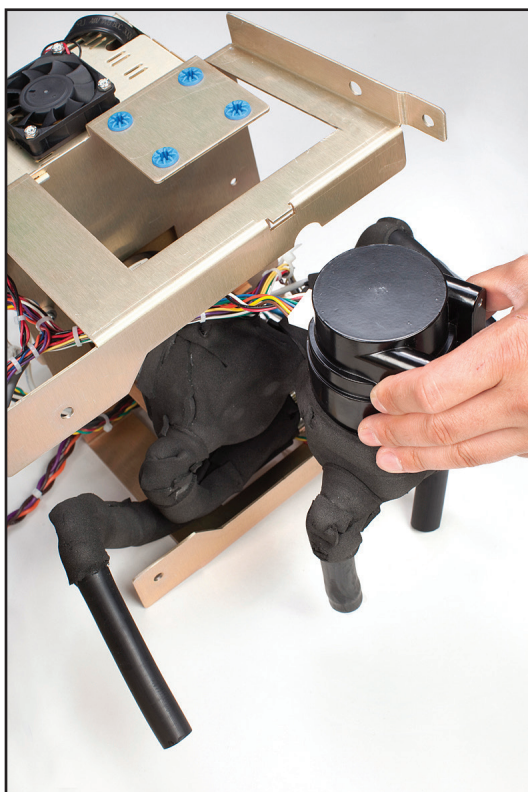
Fig. 8-31 Retire con cuidado la bomba de mezclado (paso 5)
