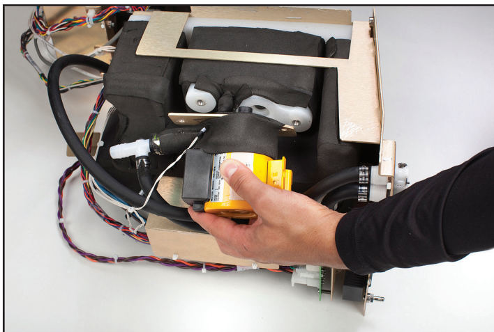
Fig. 8-42 Retirada de la bomba de refrigeración
