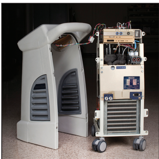
Fig. 8-13 Cubierta separada de los componentes internos
