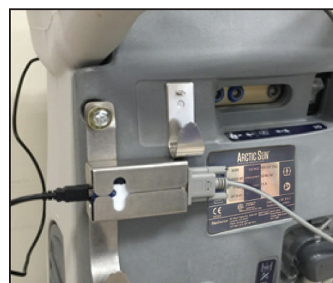
Fig. 8-74 Inserte el TIM y conecte los cables (pasos 3-5)
