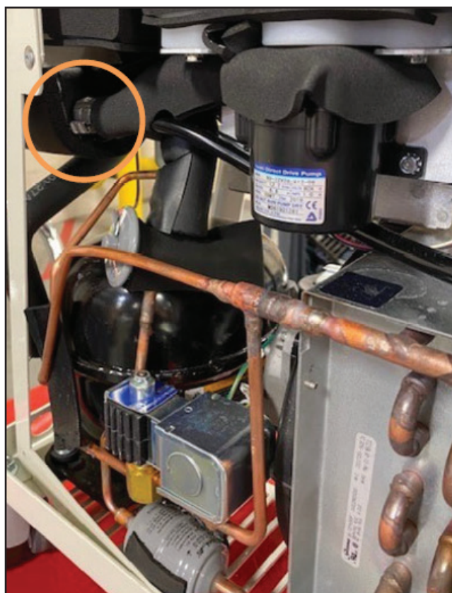
Fig. 8-22 Desconecte las dos abrazaderas (paso 3: bomba de CC)
