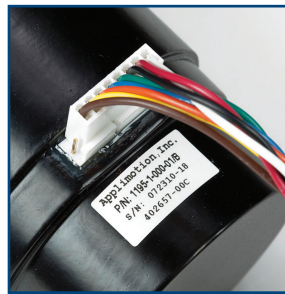
圖 8-32 連接前的幫浦接頭圖示 (上圖)；連接但一個接腳外露，安裝不正确 (左下圖)；及正確安裝 (右下圖)
