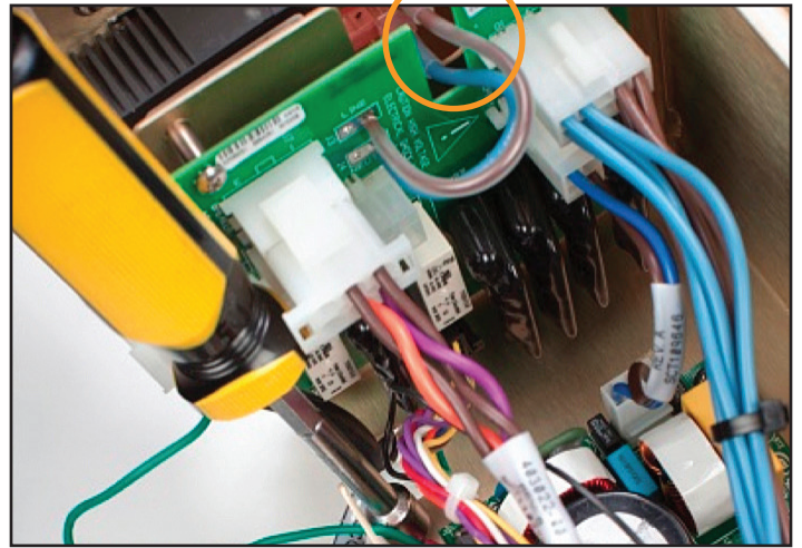
圖 8-69 放置好的電源電壓電路卡，並連接完成
