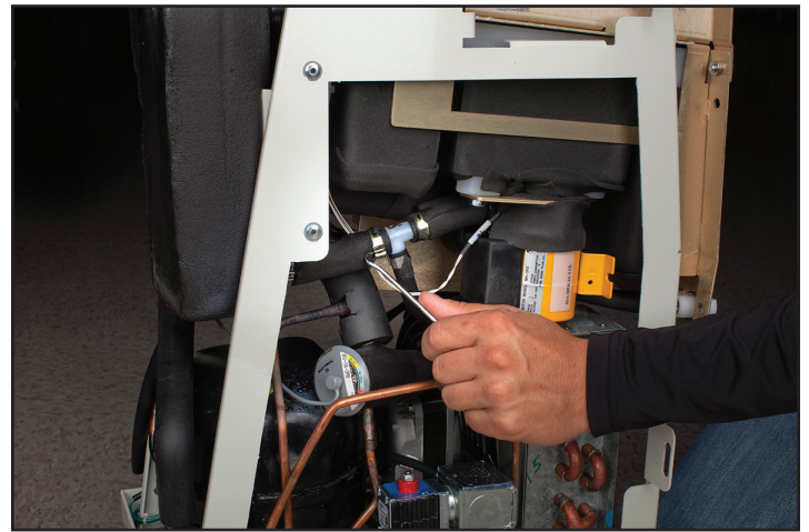
圖 8-21 打開卡扣 (步驟 3 — 交流幫浦)
