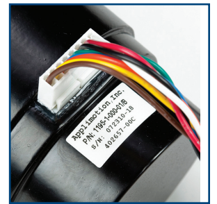
圖 8-32 連接前的幫浦接頭圖示 (上圖)；連接但一個接腳外露，安裝不正确 (左下圖)；及正確安裝 (右下圖)
