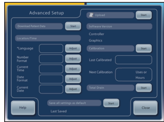
圖 8-9 「進階設定」畫面上的「全面排水」選項
