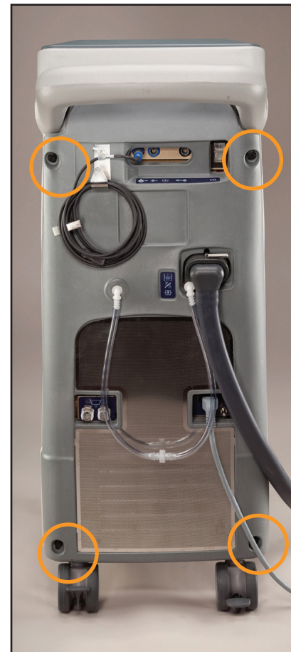
圖 8-10 背板及應移除之螺栓示意 (左方步驟 2)
