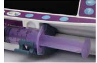
5. Apriete la pinza de liberación de la abrazadera del émbolo y deslice el mecanismo hacia la izquierda hasta que alcance el final del émbolo.
