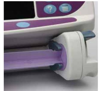
7. Asegúrese de que el tipo y tamaño de la jeringa coinciden con los mostrados en la pantalla de la bomba de jeringa Alaris™ Enteral Plus y a continuación pulse **CONFIRMAR**. Si es necesario, la marca de la jeringa se puede modificar pulsando la tecla de configuración **TIPO**.
