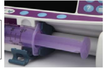
4. Relever le clamp de détection de la taille de la seringue jusqu'à ce qu'il se bloque contre le corps de la seringue.
