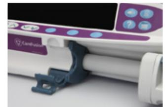
3. Installer la seringue en s'assurant que la collerette de la seringue est placée dans l'encoche du clamp de la collerette.
