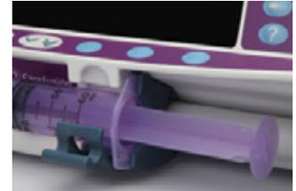
5. Actionner les pinces du chariot et faire glisser le mécanisme vers la gauche jusqu'à ce qu'il atteigne l'extrémité du piston.
