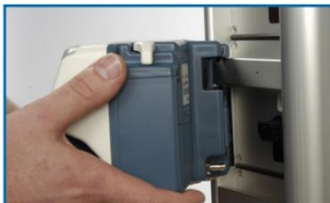
1. Richten Sie die drehbare Nocke an der Rückseite der Pumpe an der rechteckigen Schiene aus.
