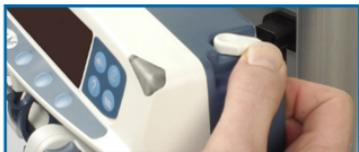
Drücken Sie zum Abnehmen der Pumpe den Lösehebel nach hinten (wie dargestellt) und ziehen Sie gleichzeitig die Pumpe mit beiden Händen nach vorn.
