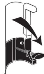
1. Ziehen Sie die eingeklappte Stativklemme nach unten und schrauben Sie die Klemme los, um genug Platz für die Stativstange zu lassen.
