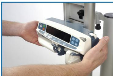
1. Achten Sie darauf, dass die Pumpe sicher positioniert ist. Prüfen Sie, ob die Pumpe fest sitzt, indem Sie sie mit beiden Händen von einer Seite zur anderen schwenken.
