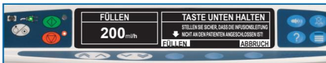
3. Drücken Sie die Taste
