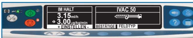
2. Achten Sie darauf, dass der Spritzentyp und die Spritzengröße den auf der Pumpe angezeigten Angaben entsprechen. Drücken Sie anschließend auf **BESTÄTIGEN**. Sie können den Spritzentyp bei Bedarf ändern, indem Sie die Multifunktions-taste **TYP** drücken.
